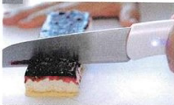
El filo del cuchillo tiene dos temperaturas y a nivel industrial permite cortar plásticos, PVC e incluso autoesterilizarse en 60 segundos.
